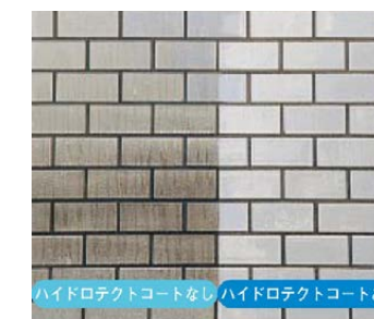
ハイドロテクトコートを用いた排気ガス汚れ洗浄テスト
