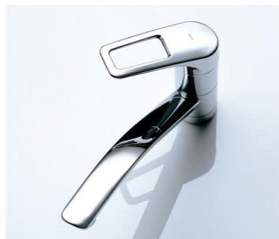
エコシングル水栓 クリック感で水と湯の境を知らせ、さらにレバー中央部まで水が出ることで湯の無駄遣いを抑えられる。
